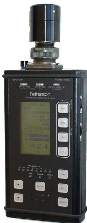
Fig. 2 - Bat detector D1000X utilizzato per il rilevamento dei chiroterri.
