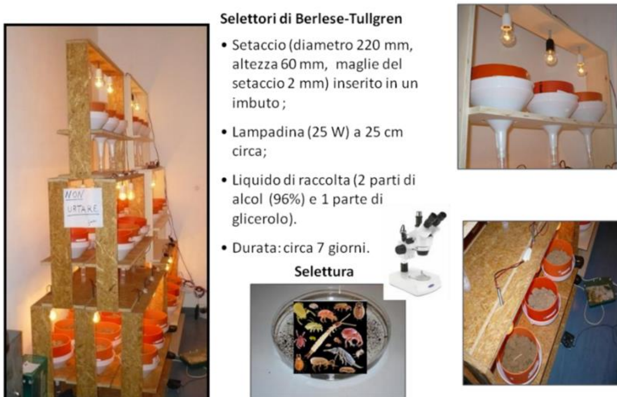
Figura 3 – Foto dei selettori di Berlese-Tullgren e sintesi del processo
