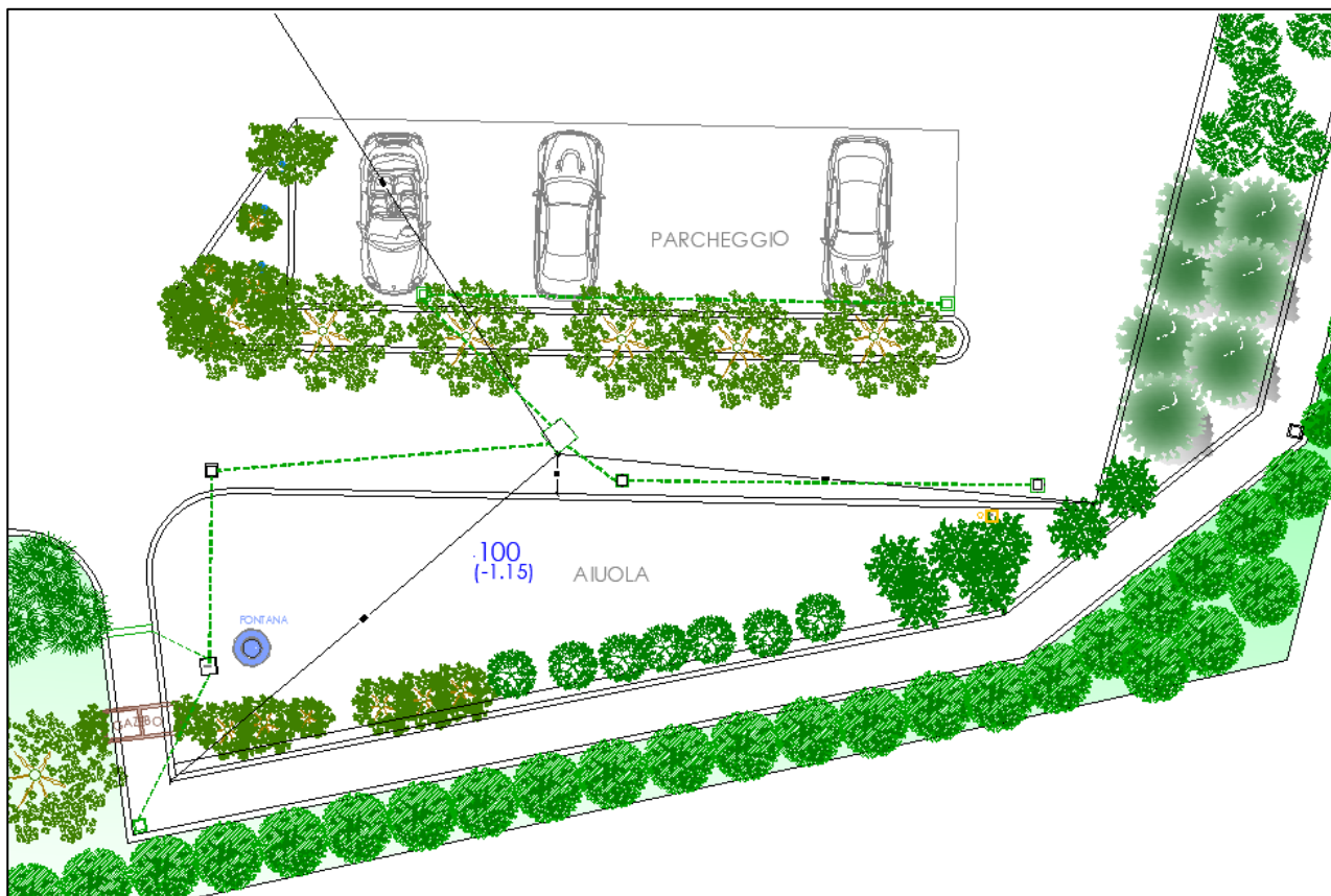
Rete di smaltimento delle acque reflue
