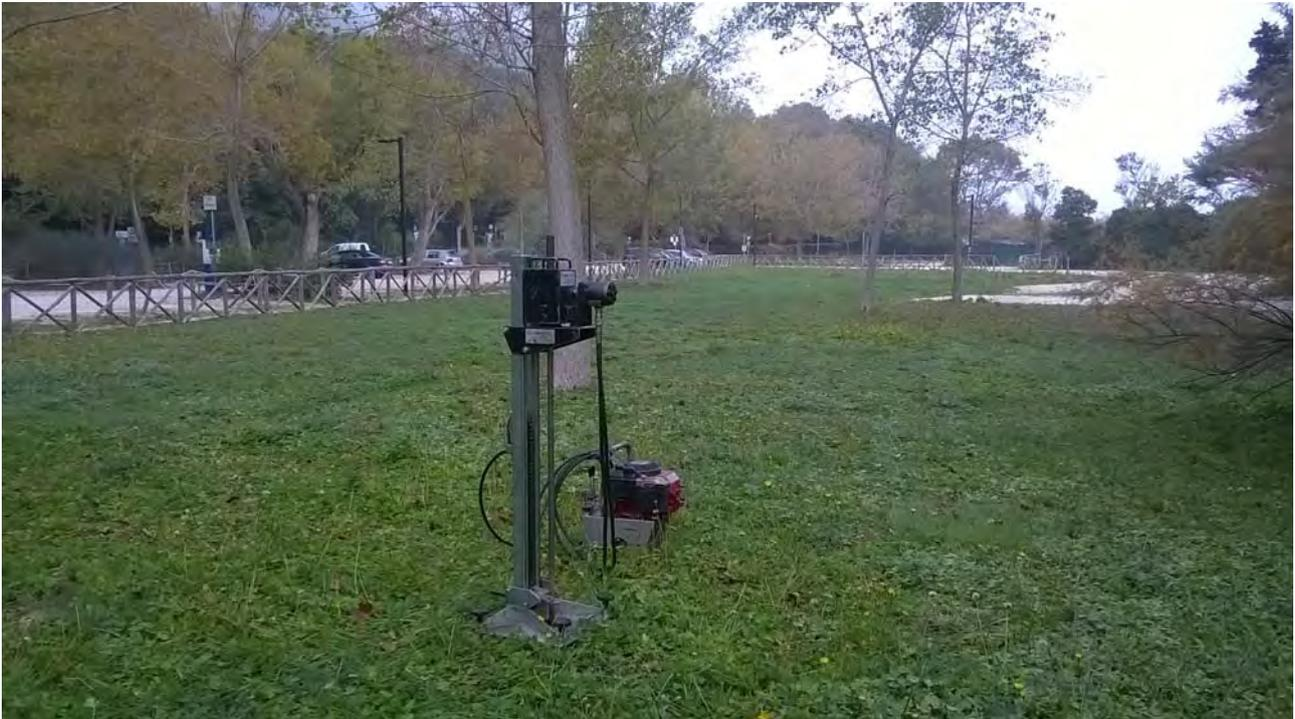
**Foto 1** – Prova penetrometrica dinamica media DM1.
