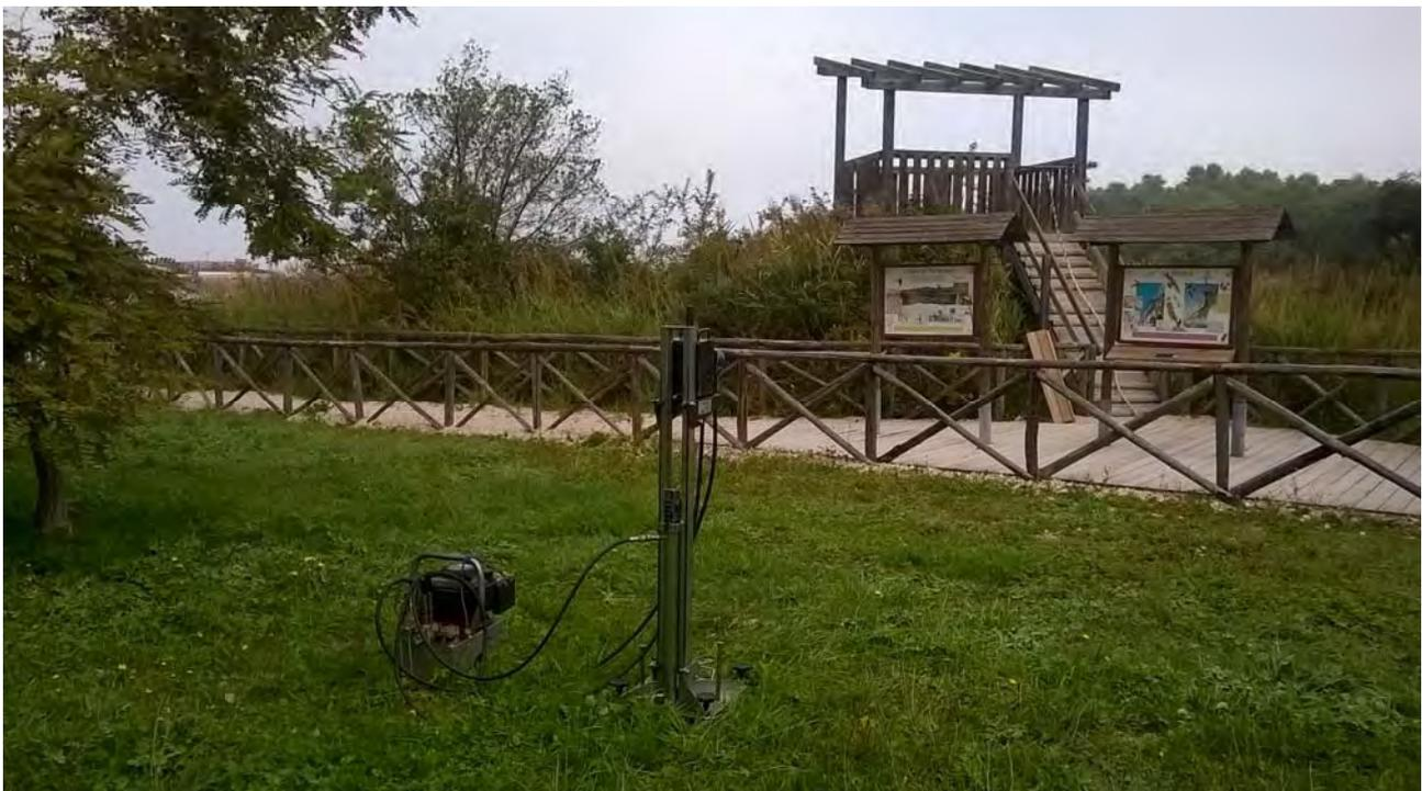
**Foto 2** – Prova penetrometrica dinamica media DM2.
