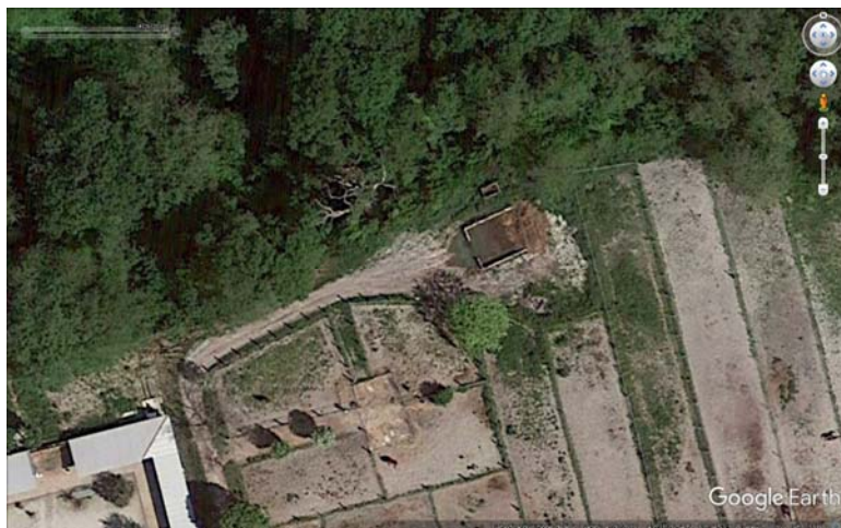
Fig. 1: concimaia da Google Earth in data 26/04/2018, sembra presente del liquido di sgrondo del letame che dall'interno fuoriesce attraverso il varco di accesso per i mezzi.
